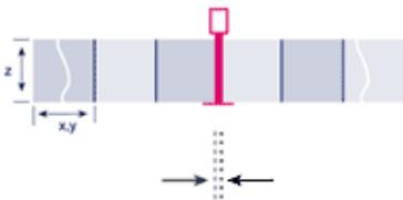
Jede Louverlux-Lichtrasterdecke erfordert eine passende Abhängekonstruktion, die sich im Wesentlichen jedoch aus Schnellspanabhängern, Wandwinkel und T-Schienen zusammensetzt.
